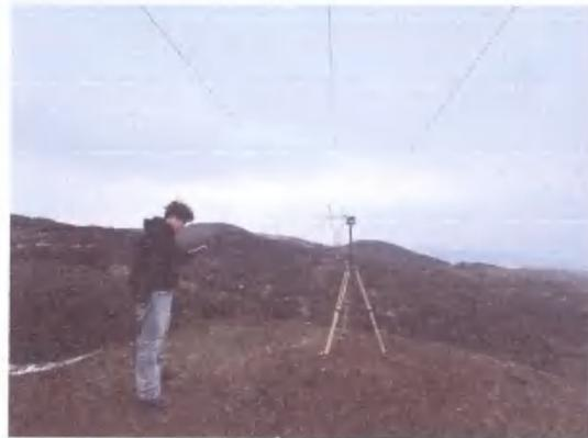
110kV 四柏线 G91~G92 段塔间现状测点 #2 (距 G91 号塔约 18m, 线高 14m) 工频电磁场检测
