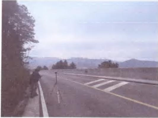
110kV 四柏线#78~#79 段塔间现状测点 #1 (距#79 号塔 110m, 线高 18m) 工频 电磁场检测
