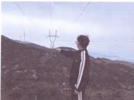
110kV 四柏线 G91~G92 段塔间现状测点 #2 (距 G91 号塔约 18m, 线高 14m) 噪声检测
