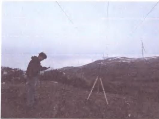
110kV 四柏线 G91~G92 段塔间现状测点 #3 (距 G92 号塔约 15m, 线高 14m) 工频电磁场检测
